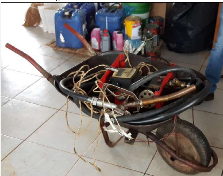
Foto 16 - Kit de abastecimento 12v – É preciso conectar na bateria do ET para funcionar. Possui vazão de 40 litros por minuto.
