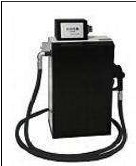
Foto 19 – Foto ilustrativa – Bomba industrial abastecimento combustíveis, 230/380 volts, anti-explosão, bico automático, 5 metros mangueira, vazão 85 litros/minuto – Marca Lupus.
