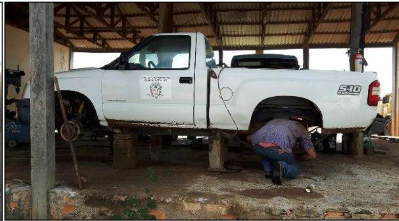
Foto 41 – E.T. elevado com tocos de madeira. Expõe a vida do mecânico ao risco de desabar sobre o mesmo.
