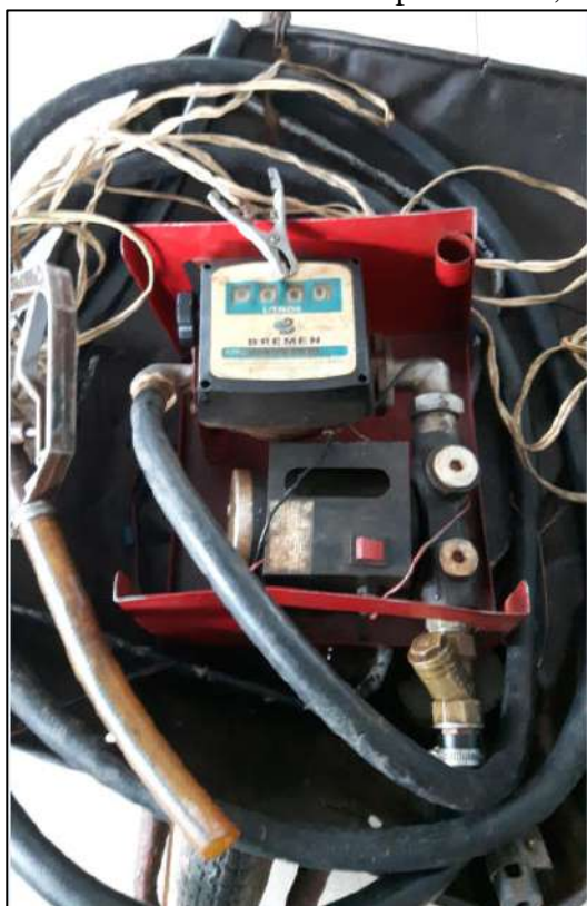
Foto 15 - Kit de abastecimento 12v – É preciso conectar na bateria do ET para funcionar.
