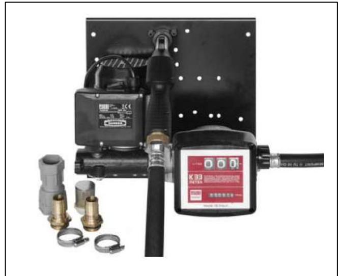
Foto 20 – Foto ilustrativa - Estação de abastecimento auto-aspirante de palhetas com válvula by-pass, mangueira 4 metros, vazão 60 L/min, 220 volts – Marca Lupus.
