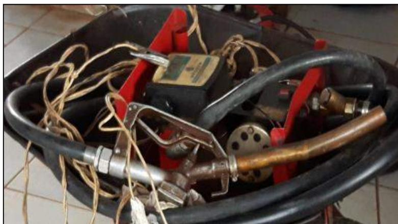
**Imagem 10** - Kit de abastecimento 12 volts – Funciona conectado a bateria do Equipamento Transporte. Este possui vazão de 40 litros por minuto.
